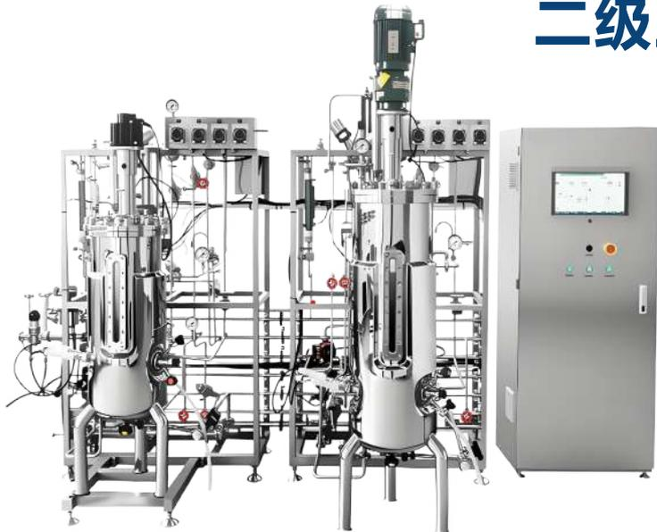
专为工艺放大与规模化生产设计，通过分级培养(种子罐、发酵罐/中间罐)实现多阶段条件控制.可根据生产规模定制罐体配置。
